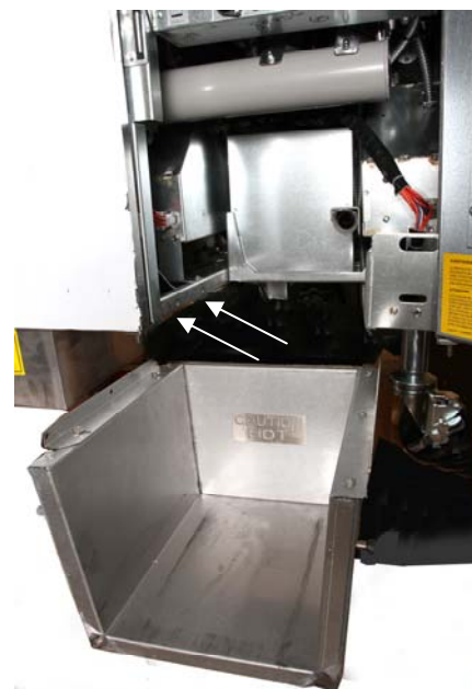
Figure 1 : Placez le bac de fusion dans l'armoire et fixez-le avec les vis fournies à l'intérieur de l'armoire.
