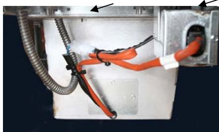
Figure 3 : Fixez les connecteurs blancs à deux broches et branchez le connecteur noir au coffret de prise de courant ainsi que montré.
